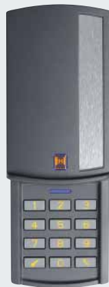
Radiocodeschakelaar FCT 10 BS met verlichte toetsen en beschermkap, tien functiecodes
