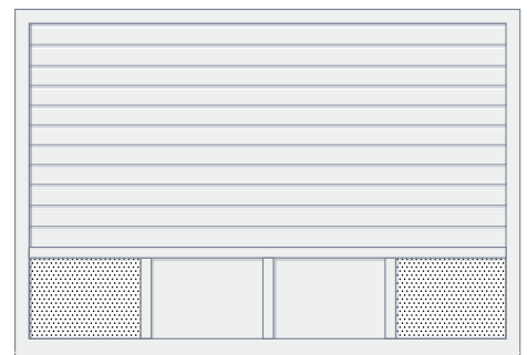
Motief 499 , voorbeeld met stalen paneelvullingen, geperforeerde plaatvullingen en vlakke aluminium plaatvullingen
