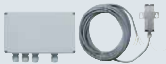
2-kanalen relaisontvanger HER 2 Met 2 potentiaalvrije relaisuitgangen, frequentie: 868 MHz, IP 65, bedrijfsspanning 24 V DC / 230-240 V AC, afzonderlijke antenne voor buitentoepassing (IP 65) in sabotageveilige aluminium behuizing met 7 m aansluitkabel, met 3 aders, analysetoestel voor binnen
