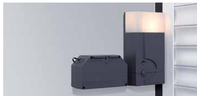
De noodaccu Door deze noodvoorziening kunt u een periode zonder netspanning tot 18 uren en 5 deurcycli overbruggen. Bij een normale werking laadt de noodaccu zich automatisch weer op.
